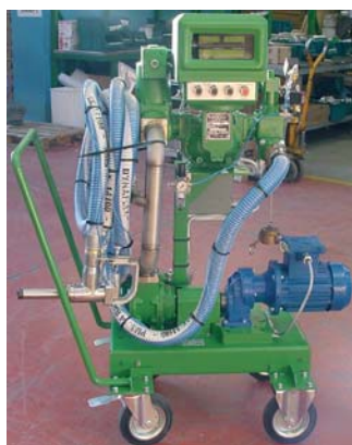
Установка для заполнения бочек растворителями
